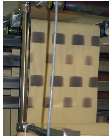
Abbildung 2: Zur Demonstration wurde an der stehenden Papierbahn das Substrat ohne Kühlung überhitzt, um den Versatz der paarweise angeordneten Wellenleiter um eine viertel Wellenlänge zu zeigen.
